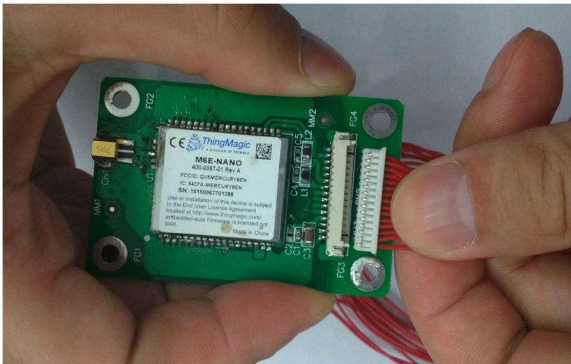
1.4 将排线的另外一端与模块底板边缘的 15PIN 排叉相连
